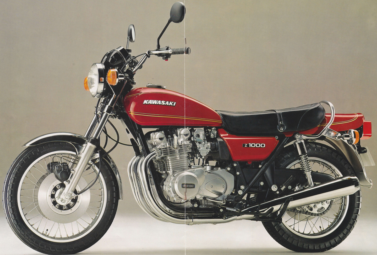
1009 ccm, Vierzylinder-Viertakt, zwei obenliegende Nockenwellen, 85 PS, vorn zwei, hinten eine Scheibenbremse.
